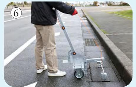
オレンジ色のロープ部を垂直に持ち上げ、 はさみ部を取り外す。 ※樹脂被膜ロープ部は、触っても安全です。
