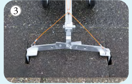
側溝ふたの手がけに、はさみ部をセットする。
